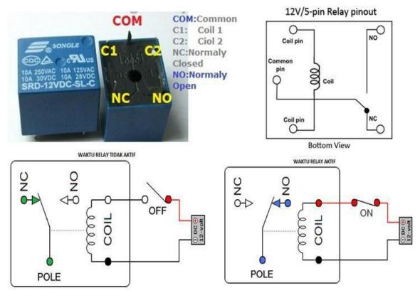
Gambar 3.6 Skema Rangkaian Elektronik *Relay* [11]
