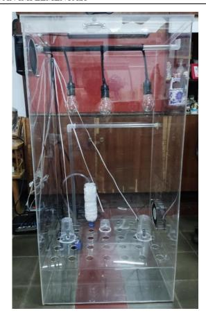
Gambar 3.11.a Tampak Depan Inkubator Anggrek
