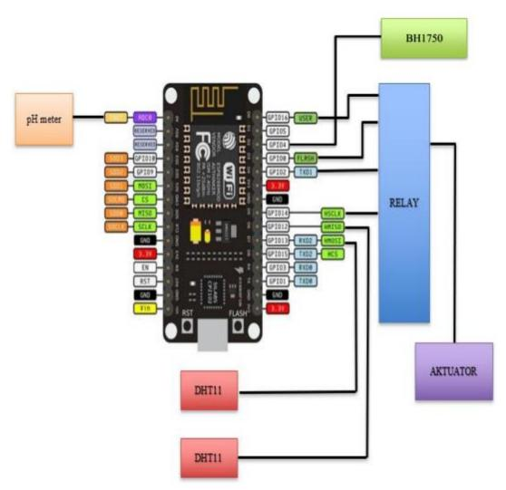
Gambar 3.2 Wiring Sistem Inkubator Tanaman Anggrek
