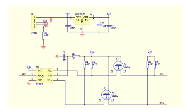
Gambar 3.5 Skema Rangkaian Elektronik Sensor BH1750 [10]
