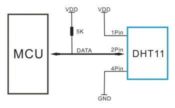
Gambar 3.4 Konfigurasi Pin Sensor Suhu DHT11 [9]
