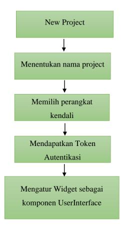
Gambar 3.9 Flowchart Merancang User Interface menggunakan Blynk
