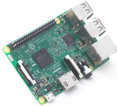
Gambar 3.3 Bentuk Fisik dari Raspberry Pi 3 Model B [21]
